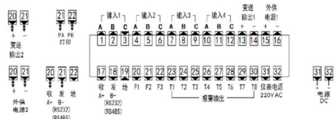
上图中, 报警输出 T1~T8 每两个端子表示一组继电器输出, 最多可输出 4 个继电器。
